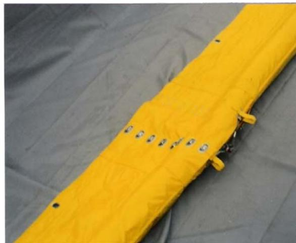
Die WU-Schwemmholz- und Treibgutsperrung kann auf herkömmliche WU-Haspelsysteme aufgewickelt werden. Die dem aktuellen technischen Stand entsprechenden Auf- und Abrollsysteme weisen einen hydraulischen Antrieb auf, womit sich bis zu 500 m der neuen Sperre problemlos und fachgerecht auf- und abwickeln lassen.
